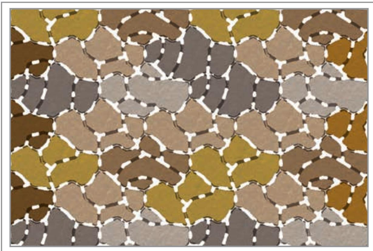
Sur le schéma de pose, chacun des sept pavés est représenté avec une couleur différente. Tous ces sept éléments qui composent le revêtement de sol OPUS sont caractérisés par le fait qu'ils ont le même périmètre et la même surface de pose, de façon à pouvoir être parfaitement encastrés et substitués entre eux pour créer l'effet irrégulier caractéristique de l'OPUS INCERTUM en pierre naturelle.
