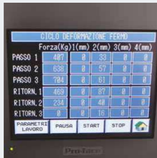
LETTURA TEST PROVE CON STAMPA AUTOMATICA DEL RAPPORTO. READING OF TEST'S CYCLES WITH AUTOMATIC PRINTING.
