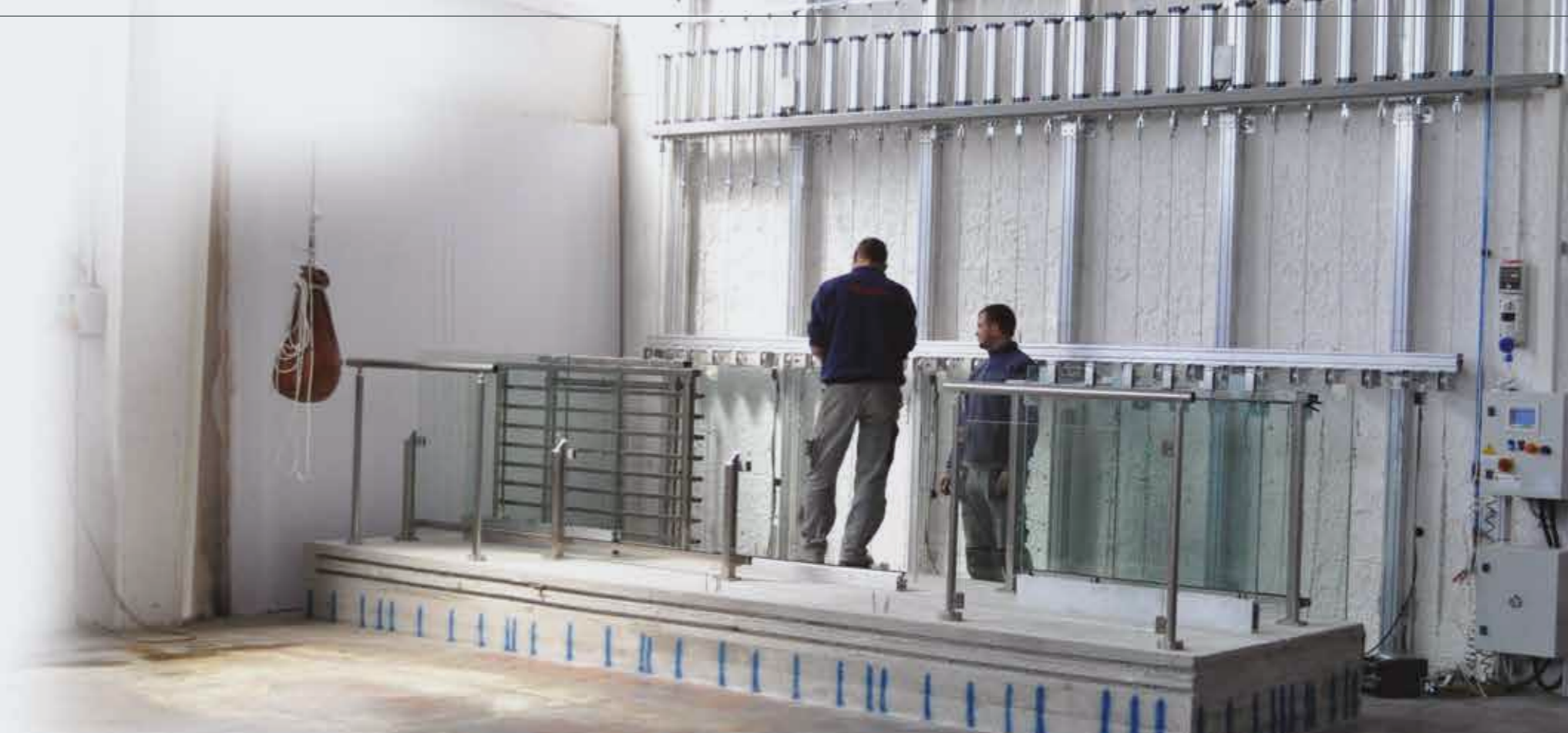
PROVA PENDOLO DA ALTEZZA DI 120 cm. IMPACT TEST FROM A HEIGHT OF 120 cm.
