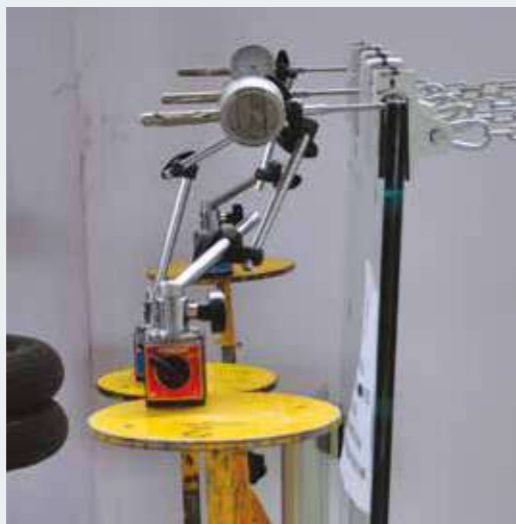
ESEMPIO MISURATORI DI FLESSIONE. EXAMPLE OF BENDING MEASUREMENTS.
