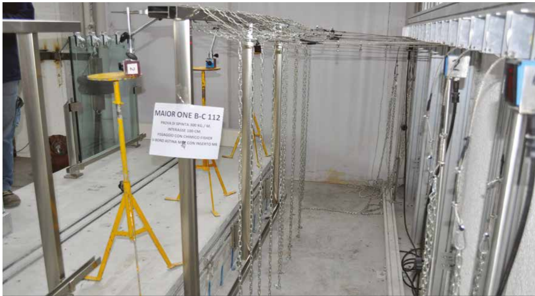
PROVA MAIOR CON MONTAGGIO SU FRONTE SOLAIO. TESTS OF MAIOR WITH FASCIA MOUNTING.
