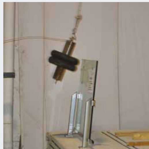
PROVA CON RUOTA DA ALTEZZA DI 120 cm. WHEEL TEST FROM A HEIGHT OF 120 cm.
