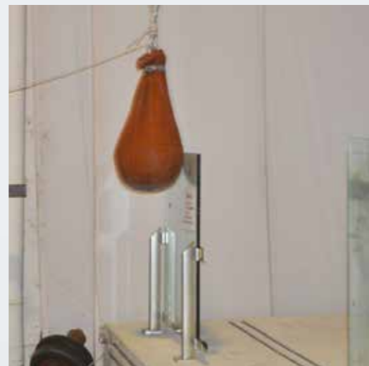
PROVA PENDOLO DA ALTEZZA DI 120 cm. IMPACT TEST FROM A HEIGHT OF 120 cm.
